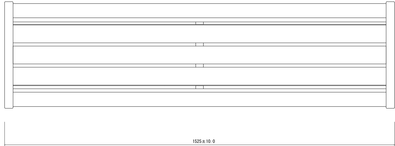
座板断面詳細図 S=1/2
