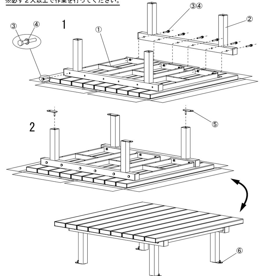
座面が水平になるようにアンカープレートを回転させて調整します。
