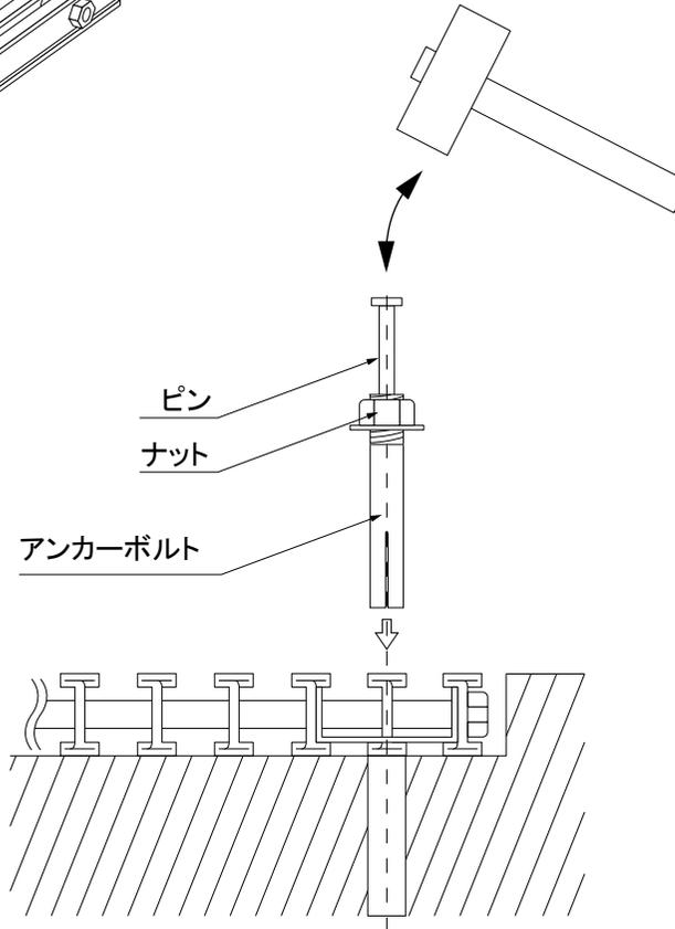
②アンカープレート穴にアンカーボルトを落とし込み、ピンを打ち込みます。
