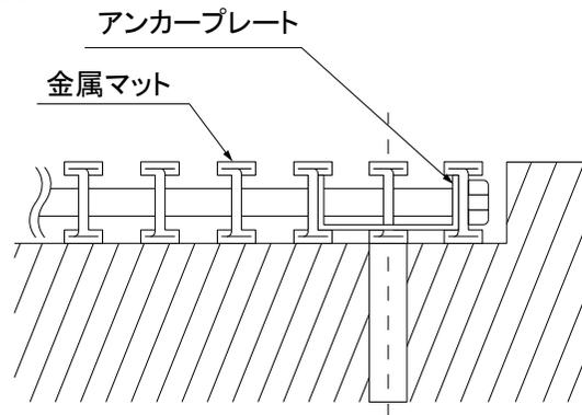
①マットを仮設置後、アンカープレートのアンカーボルト取付穴部分より直接設置場所の地面へ振動ドリル(刃はコンクリート用)でアンカーボルトより0.5mm ~ 1mm程度大きめの穴を少し深めにあけます。
