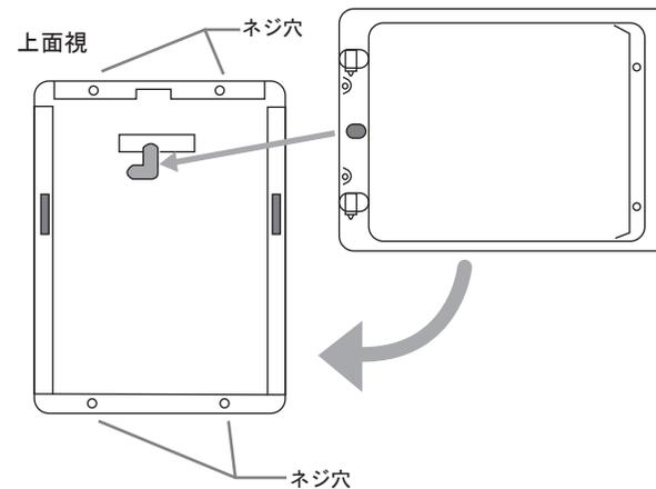
1. 最初に上蓋をはずした状態で、本体に口枠を横にしなが本体から出ている鉄芯を口枠の上部穴に通してください。
