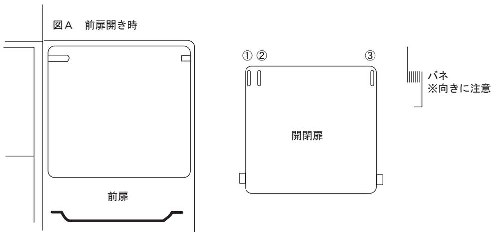
1. 最初に扉を開けた状態で、開閉扉を①の方向から入れてください。3分の1程度差し込んだら①と②の間に図Bのような向きで入れてください。最後に③の部分を開閉扉を少し押し歪ませてはめてください。この状態ではまだバネは効いておらず、先端が真っ直ぐ開閉扉の上から飛び出した状態になっています。
